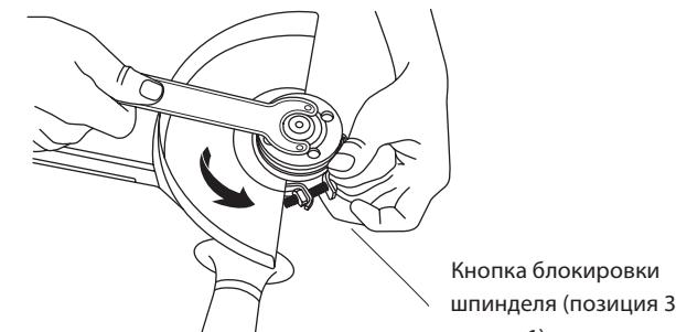
Кнопка блокировки шпинделя (позиция 3 на рис. 1)
