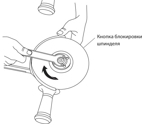
Кнопка блокировки шпинделя
