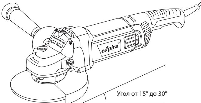
4. Осторожно перемещайте УШМ вдоль детали. Не торопитесь, дайте инструменту время на выполнение работы. Обычно не возникает необходимости давить на диск. Во время работы в моторном отсеке могут возникать искры. Это нормально и не означает неисправности.
