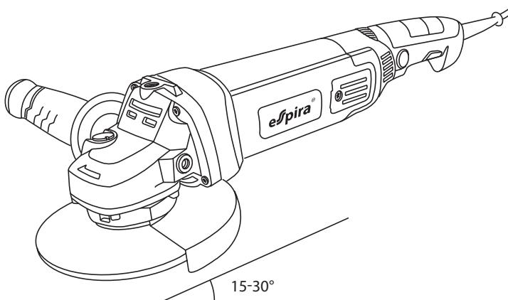
4. Осторожно перемещайте УШМ вдоль детали. Не торопитесь, дайте инструменту время на выполнение работы. Обычно не возникает необходимости давить на диск. Во время работы в моторном отсеке могут возникать искры. Это нормально и не означает неисправности.
