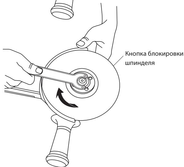
Кнопка блокировки шпинделя
