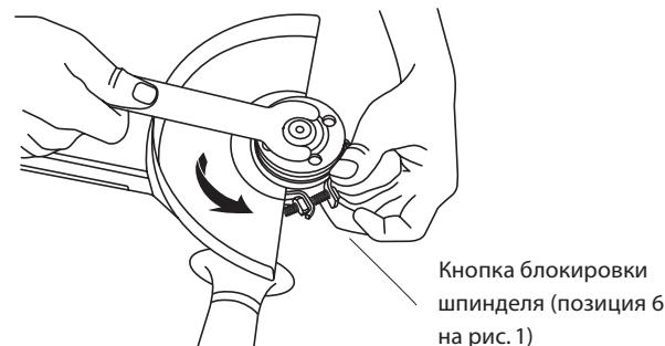
Кнопка блокировки шпинделя (позиция 6 на рис. 1)
